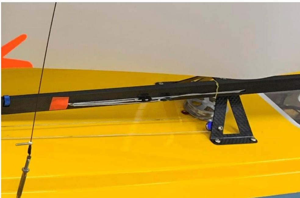
图 2.6 收锁机连接的轮盘（银色轮盘）
