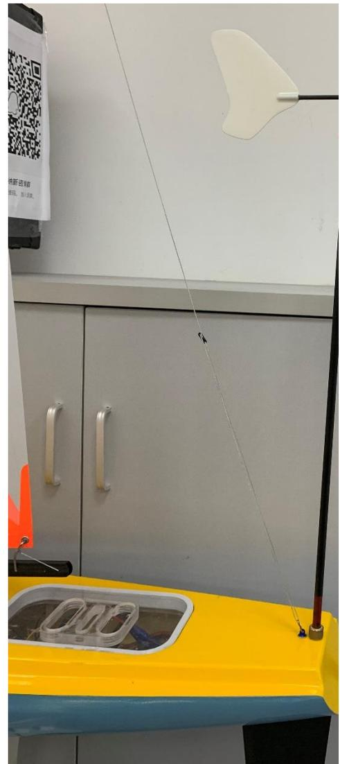
图 2.12 后支索线（左为大图，右为连接处特写图）
