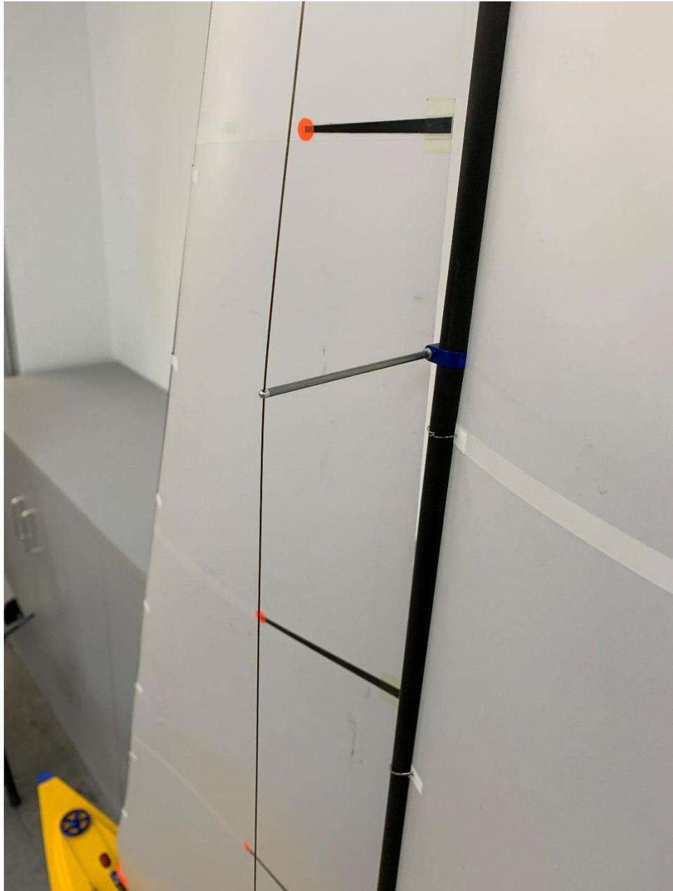
图 2.10 主桅的左右侧支索钢丝特写
